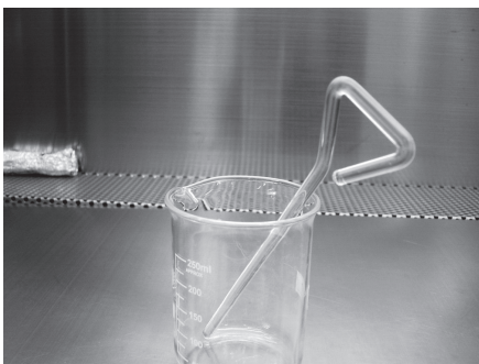
玻璃塗抹棒 (bent glass rod)：用來做為培養皿上塗抹用途，可將微生物的樣本均勻塗抹在培養皿上。
