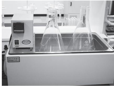
恆溫水浴槽 (water bath)：利用水做為媒介，可調整並維持穩定溫度的儀器。
