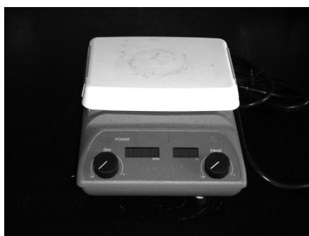
電磁加熱攪拌器 (magnetic stirrer) : 具有磁場及加熱功能，可用來配製溶液並附帶攪拌功用。
