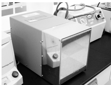
鐵胃 (stomacher) : 利用強力敲打的两片藥片，可使微生物的前處理樣品達到均質均勻的目的。
