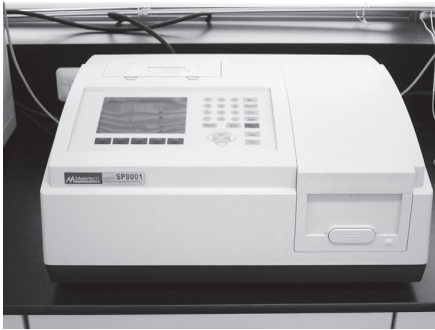
紫外光 - 可見光分光光度計 (spectrophotometer)：利用紫外光及可見光測量光的強度，進行物質的分析，屬於光譜儀的一類。
