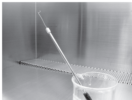
接種環 (incubation loop)：用來接種微生物用的器具。
