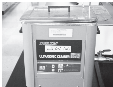
超音波震盪機 (ultrasonic cleaner)：利用超音波原理，實驗中，可幫助將配置的溶液氣泡去除，亦可做為器具清洗之用途。
