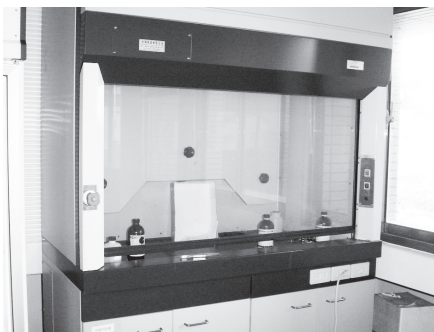
抽氣櫃 (hood)：具有抽氣設備的實驗操作環境，可防止有毒有害氣體滲入到實驗室。
