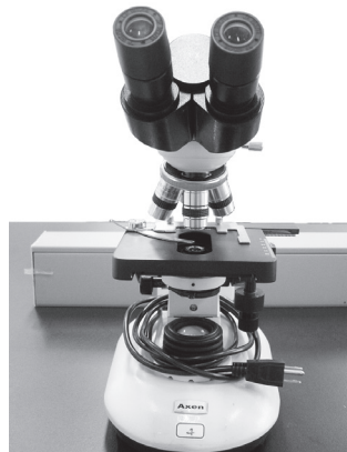
光學顯微鏡 (microscope)：由目鏡及物鏡所組成，可以放大倍率，用來觀察微生物的生長型態。
